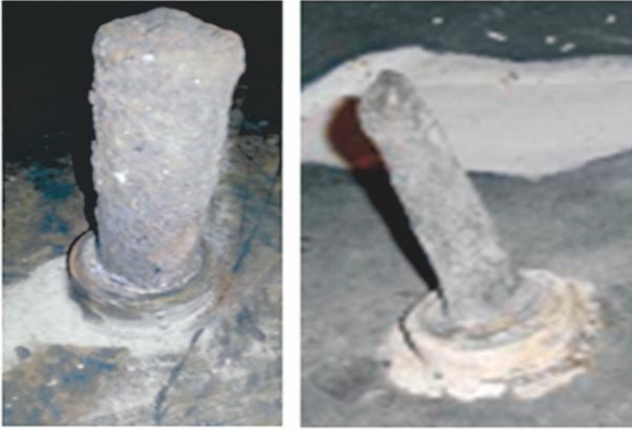
[그림 2] Pb-Ag anode in steam condenser
