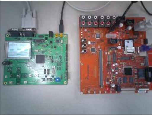
그림 6. ECU 시뮬레이터와 ECU 관리자의 연결 모습
