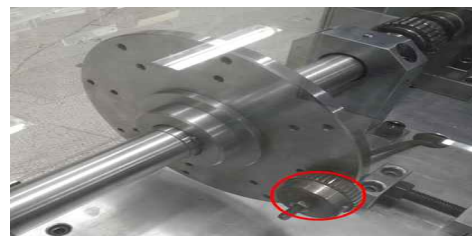
그림 10. 질량 불평형 발생 Fig. 10. Generation of mass unbalance
