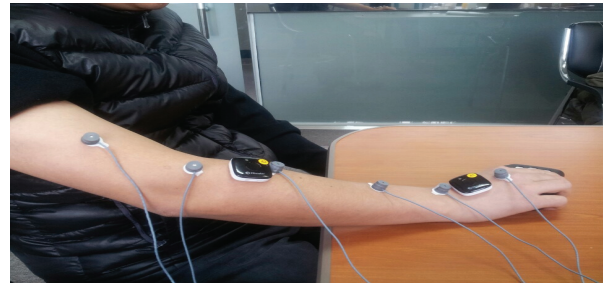
그림 5. Attachment of Fitmeter Accelerometer and CMS-70P
