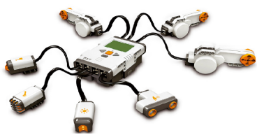
그림 1. NXT 시스템의 구성 Fig. 1. Configuration of NXT System.
