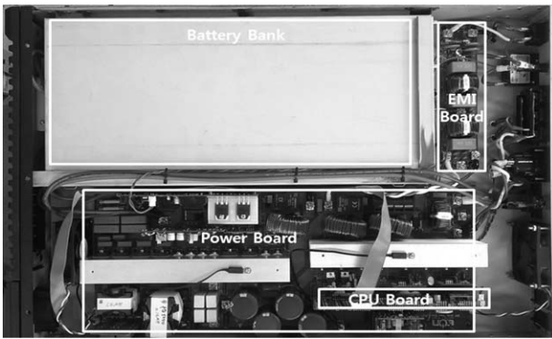
그림 3 3kVA UPS 내부 사진
