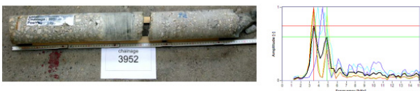
Fig. 9 Chainage 3952의 콘크리트 코어 및 대응되는 FFT 결과
