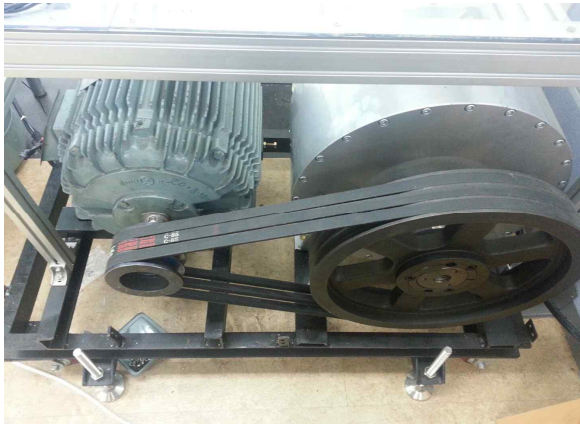
그림 7. 3상 유도전동기와 PMSG의 연결 사진 Fig. 7. Inter connection figure of 3 phase induction motor and PMSG
