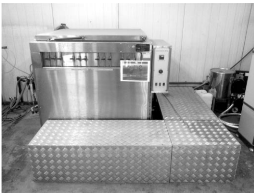
[그림 7] ETSP(열간내압크리프시험) 성능평가 (125psi/170hr)
