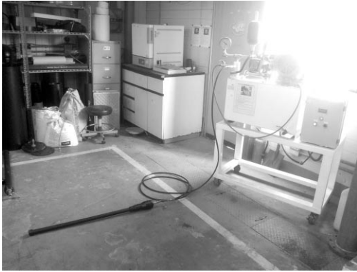
[그림 8] STBS(단기수압성능시험) 성능평가 (500psi/23℃)
