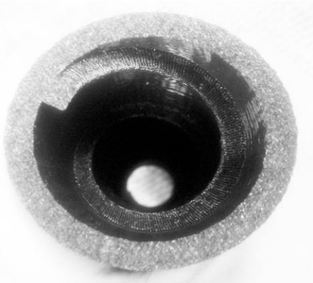
[그림 3] 내부나선형 HDPE Pipe 샘플1 (3D Print FDM)
