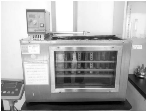
[그림 6] ESCR (내환경응력균열시험) 성능평가 (20%/600hr)
