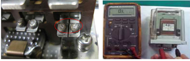
그림 3. Rax-L440-A 계전기 고장 형태 Fig. 3. Failure case of Rax-L440-A relay
