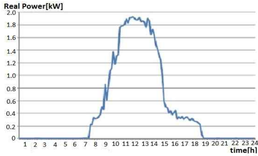
그림 2. 최적에 가까운 조건에서의 PV 출력전력 예 Fig. 2. Example of PV source output real power in nearly optimal condition
