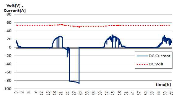
그림 5. 리튬 배터리의 DC 전압과 전류 Fig. 5. DC voltage and current of Li battery
