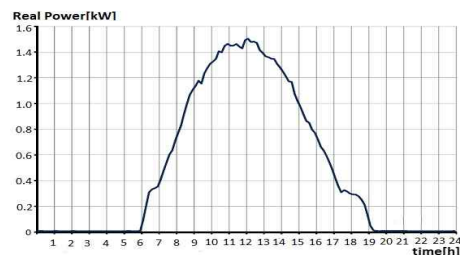
그림 9. PV 패널 출력전력의 평균값 Fig. 9. Average value of PV panel output power
