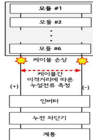
그림 4. 침수된 태양광 모듈의 손상된 (+) 케이블과 (-) 케이블의 이격 거리에 따른 누설전류 측정 Fig. 4. Leakage current measurement according to the distance between damaged (+) cable and (-) cable of flooded photovoltaic module
