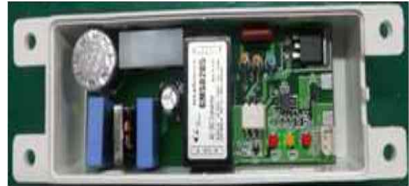
사진 1. 개발된 온도 제어기 내부 사진 Photo 1. Inside photo of anti-freezing heating cable temperature controller developed
