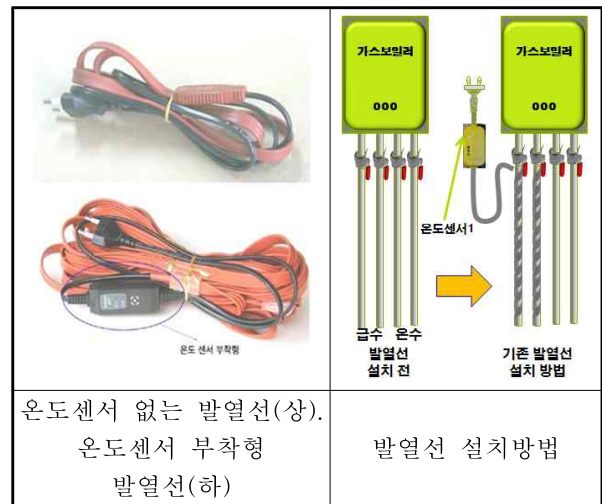
그림 2. 발열선과 발열선 설치방법 Fig. 2. Heating Cable and its heating cable installation method
