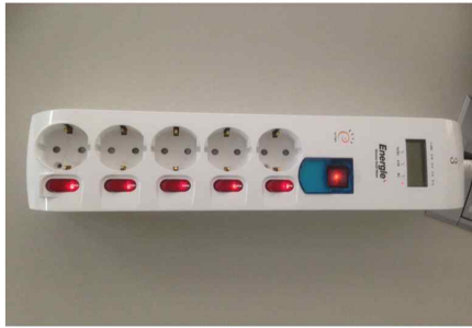
그림 4. Zigbee방식의 멀티탭 전력 측정 Fig. 4. Zigbee support power measure
