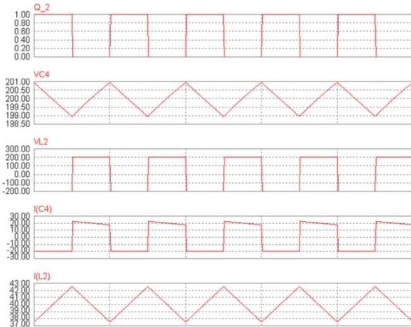
그림 13. L2, C4에 대한 전압/ 전류 파형 Fig. 13. Voltage and current of L2 and C4
