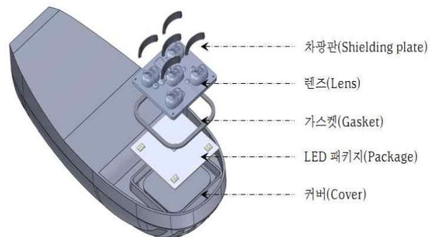
그림 1. LED 조명기구 모델링을 위한 주요 부품
