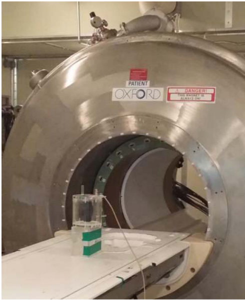
그림 3. MRI 마그넷 근처에 설치한 솔레노이드 코일 시스템. Fig 3. The solenoid coil installed at the vicinity of the 3T MRI magnet.
