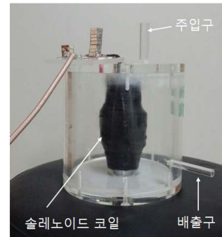
그림 1. 코일을 냉각하기 위한 수냉각 시스템. Fig 1. Water cooling system to cool the RF coil.
