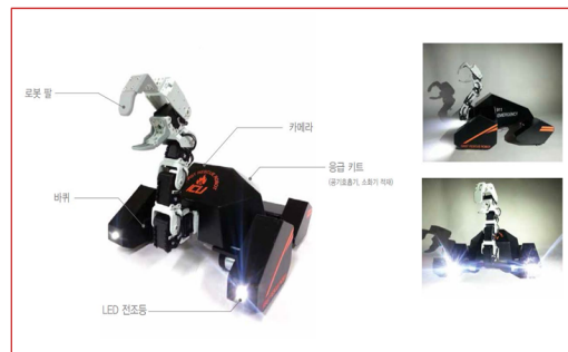
그림 11. 원격조정 로봇의 구조 및 실제 동작 사진 Fig. 11. Photography of Remote control Robot Architecture and practical operation
