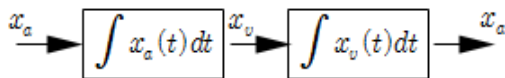
그림 1. 이중적분을 통한 가속도의 위치데이터 변환 Fig. 1. Calculation of position data from acceleration data
