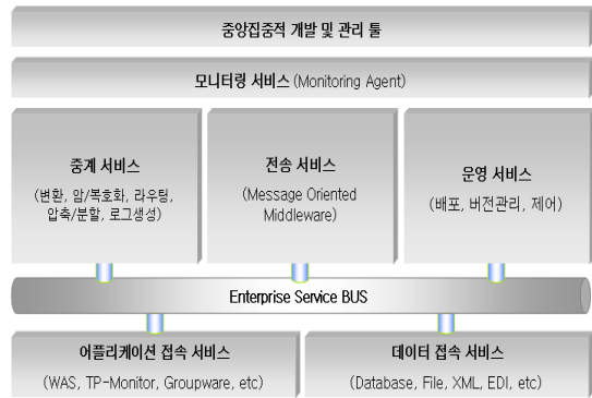
그림 1. ESB의 주요 컴포넌트 구조 Fig. 1. Main Component Structure of ESB
