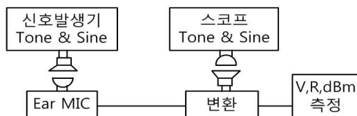
그림 2. MIC 측정을 위한 시스템 구조 Fig. 2. System structure for mic measurement.
