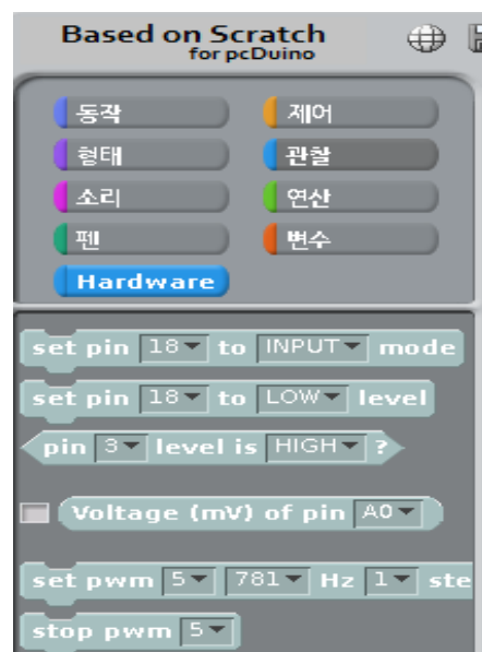
<그림 6> 피시듀이노의 스크래치 GPIO 관련 명령 블록
