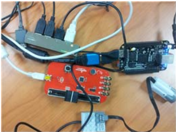
<그림 3> 비글본블랙에 센서보드와 WEDO 모터를 연결
