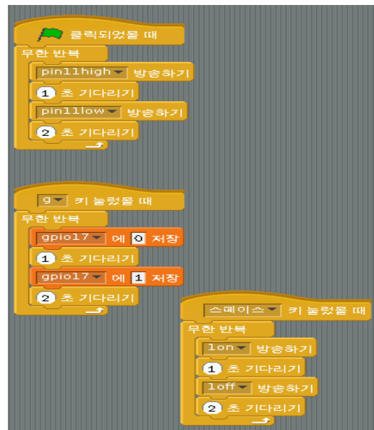
<그림 5>라즈베리 파이보드 GPIO 명령
