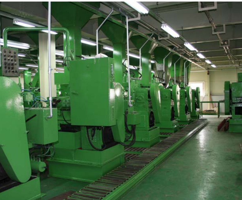
영화테크가 영화금속으로부터 인수한 나사식 가단 주철제 관 이음쇠 가공·생산설비
