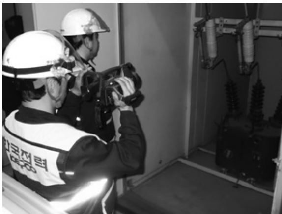
[그림 5] 잠실야구장 열화상 및 계전기 상태 정밀진단 지원
