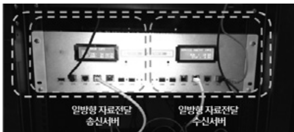
[그림 2] 일방향 자료전달시스템 개요 및 시제품
