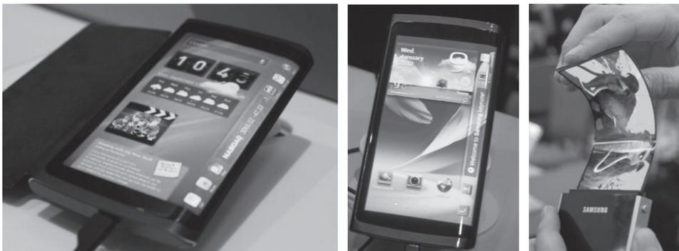
그림 2. 스마트폰용 Flexible AMOLED 디스플레이 (삼성디스플레이)
