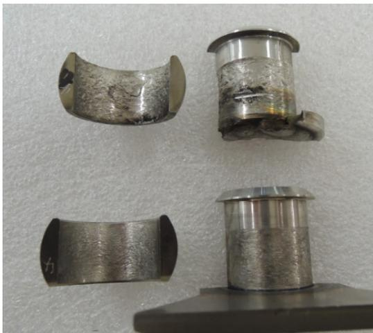
그림 4 회전 모멘트 시험 후의 내부형 김발 신축이음
