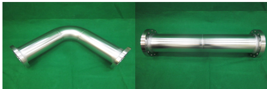
그림 8. 제작 완료된 배관 시편 (좌: 곡관, A형, 우: 직관, B형)
