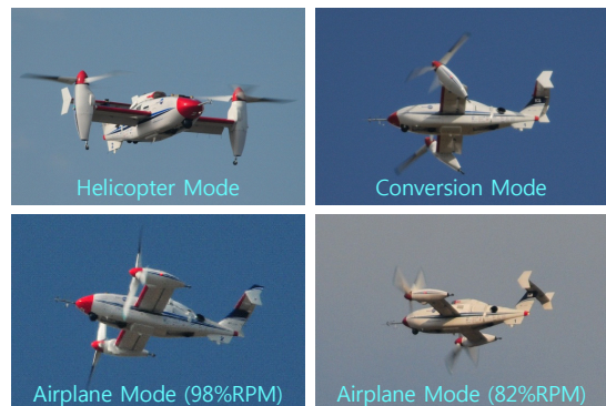
그림 1. 스마트무인기의 각 모드별 비행시험
