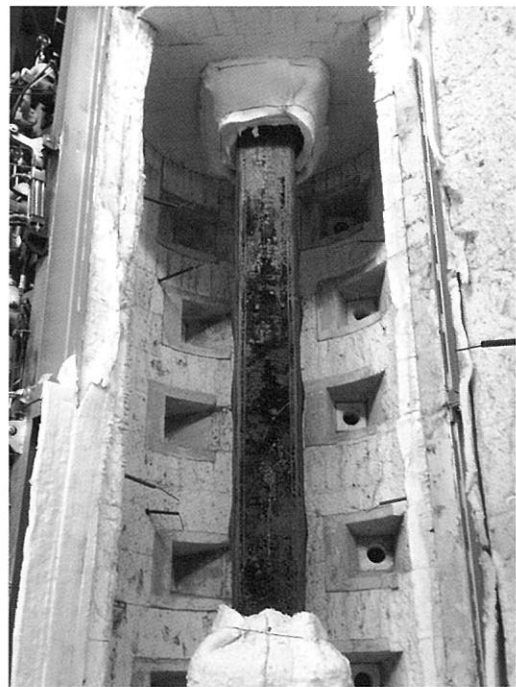
[그림 6] 내화실험후 실험체 형상(RIST-HIT CFT400P)
