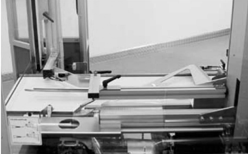
◀ Pilz가 제공하는 광전자식 보호 장치 PSENopt 덕분에 안전하고 효율적인 포장기계 로드
