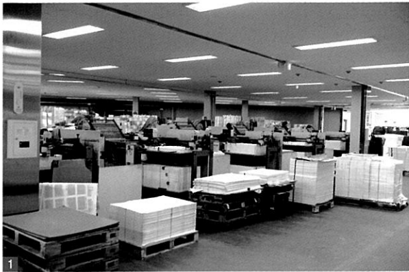
1. 제작 속도를 가능하는 척도의 하나인 접지기, (주)바이블코리아에는 20여대의 접지기를 보유하고 있다. 2. 접지된 내용물을 순서대로 배열하는 정합기, (주)바이블코리아는 최첨단 정합 시설을 보유하고 있다. 3. 지난 13년간 제작한 표지를 모아놓고 샘플처럼 활용하고 있다.
