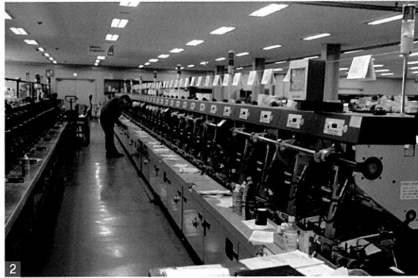
1. 제작 속도를 가능하는 척도의 하나인 접지기, (주)바이블코리아에는 20여대의 접지기를 보유하고 있다. 2. 접지된 내용물을 순서대로 배열하는 정합기, (주)바이블코리아는 최첨단 정합 시설을 보유하고 있다. 3. 지난 13년간 제작한 표지를 모아놓고 샘플처럼 활용하고 있다.
