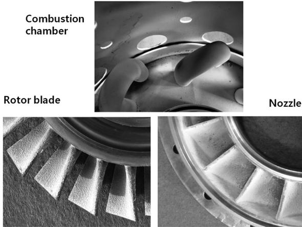
[그림 6] ISCC 공정으로 내열, 내산화 코팅층이 입혀진 100k급 가스터빈 부품
