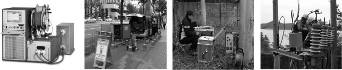
[그림 1] 차량설치형 VLF 진단 및 Portable VLF 진단(해저케이블)
