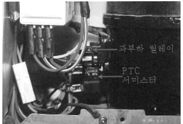
Fig. 2. PTC 서미스터 및 과부하 릴레이
