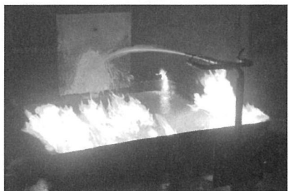
그림 13. B급화재 소화시험(ISO, IMO, 저팽창포)
