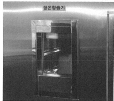
그림 7. 항온조에서 시험 중인 포소화약제
