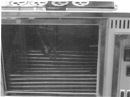
그림 4. 케논-펜스케 점도계를 사용한 점도측정
