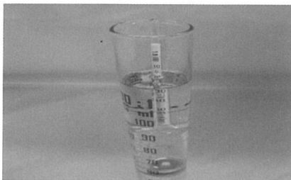
그림 6. 비중계를 이용한 비중측정
