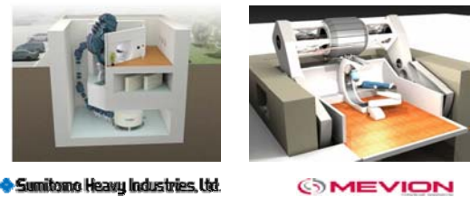
(그림 3) 1 사이클로트론/ 1 겐트리 형태의 compact형 양성자치료기
