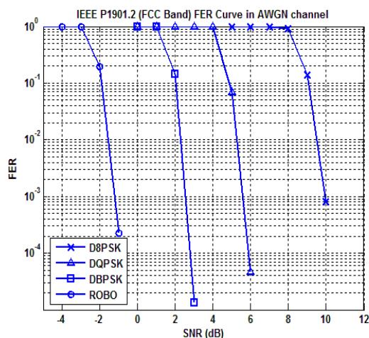
그림 3. AWGN 채널환경 하에서 IEEE P1901.2 시스템의 SNR대비 FER 성능
