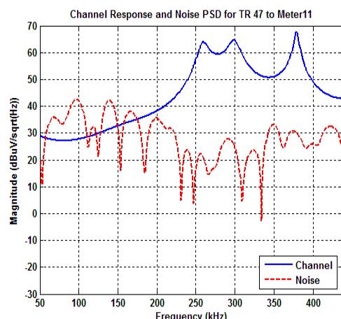
그림 8. 47번 변압기로부터 11번 계량기 방향의 채널 응답과 잡음 PSD
