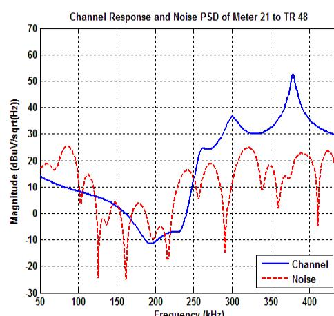
그림 11. 21번 계량기로부터 48번 변압기 방향의 채널 응답과 잡음 PSD
