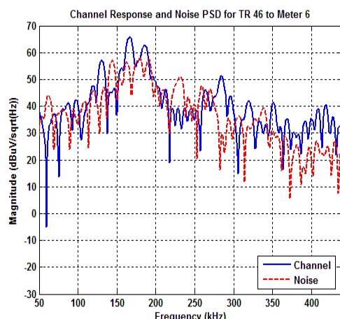
그림 6. 46번 변압기로부터 6번 계량기 방향의 채널 응답과 잡음 PSD
