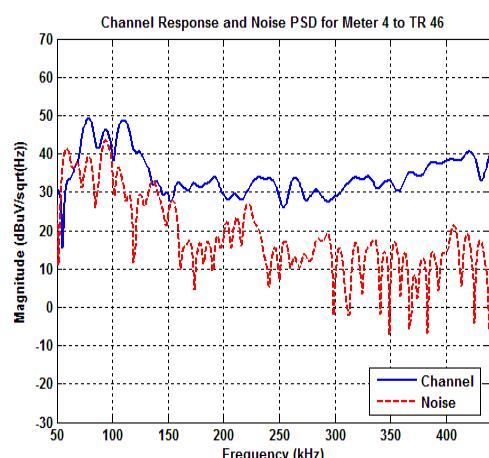
그림 5. 4번 계량기로부터 46번 변압기 방향의 채널 응답과 잡음 PSD
