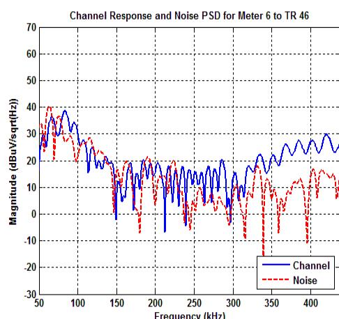
그림 7. 6번 계량기로부터 46번 변압기 방향의 채널 응답과 잡음 PSD
