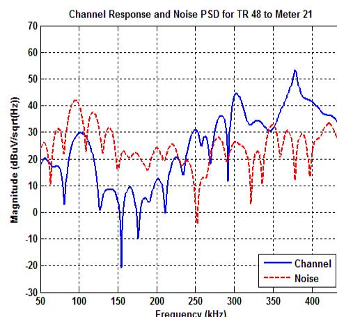
그림 10. 48번 변압기로부터 21번 계량기 방향의 채널 응답과 잡음 PSD
