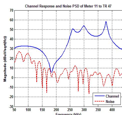
그림 9. 11번 계량기로부터 47번 변압기 방향의 채널 응답과 잡음 PSD
