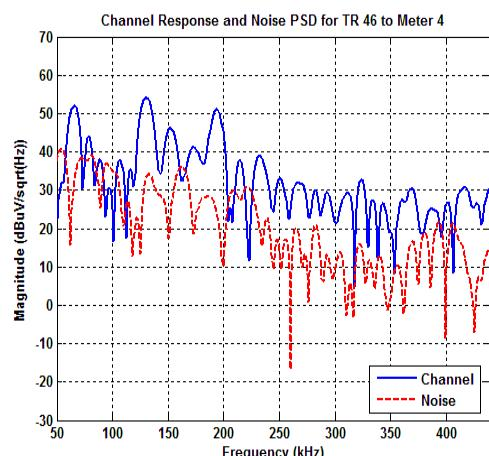
그림 4. 46번 변압기로부터 4번 계량기 방향의 채널 응답과 잡음 PSD
