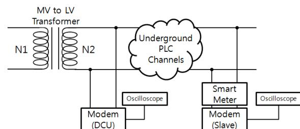
그림 1. 채널 특성 측정 구성
