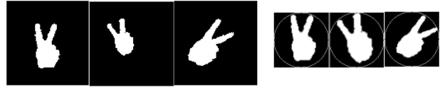
그림 3. 정규화 전(좌)과 정규화 후(우)의 손 이미지 Fig. 3. Hand image before and after normalization.
