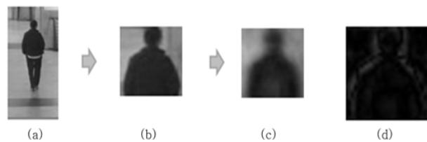
그림 5. 보행자의 머리 어깨 영역에서 원영상과 PCA 복원 영상간의 차영상 생성 (a) 검출 윈도우 생성, (b) 추출된 머리 어깨 영역, (c) PCA 복원영상, (d) (b)와(c)의 절대값 차영상
