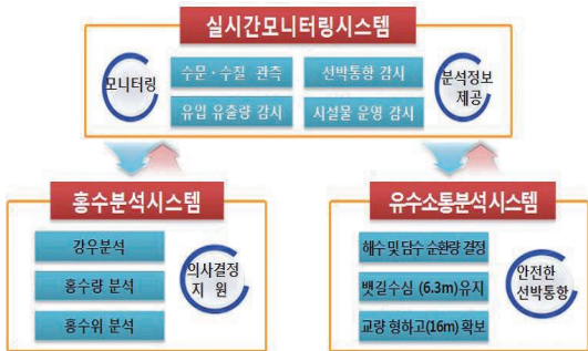
그림 9. 아라천 물관리시스템 구성도
