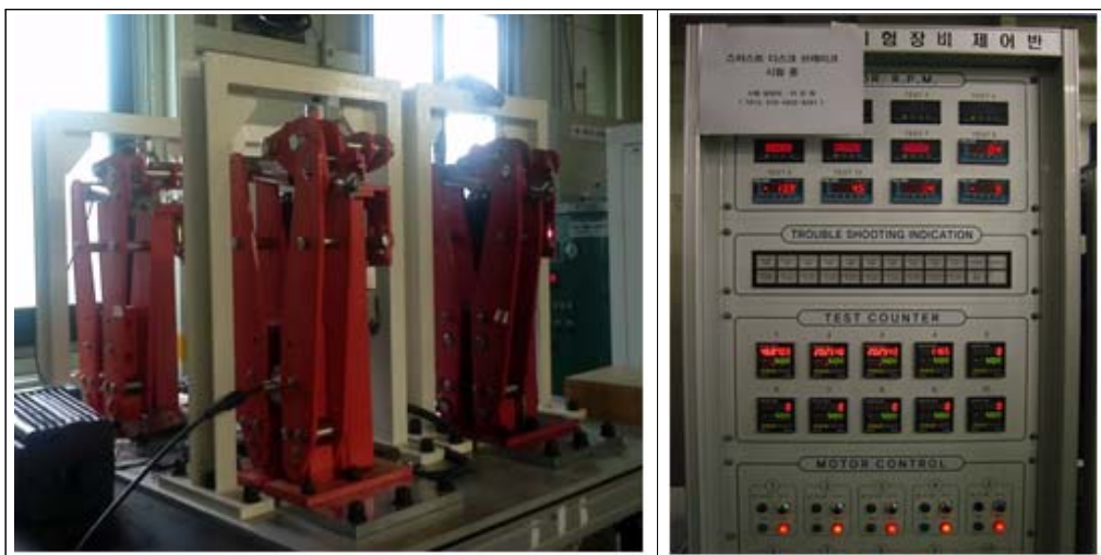
<그림 7> 쓰러스터 브레이크의 수명시험 및 제어반
