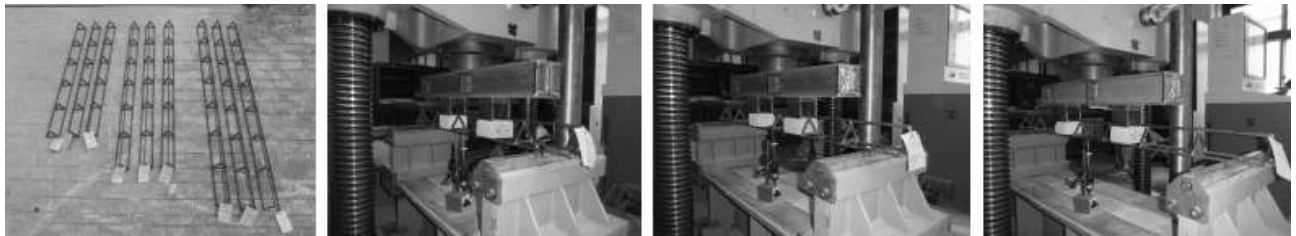
a. 강재 트러스 인방 실험체 b. 6t_1000 실험체 셋팅현황 c. 6t_1200 실험체 셋팅현황 d. 6t_1400 실험체 셋팅현황
