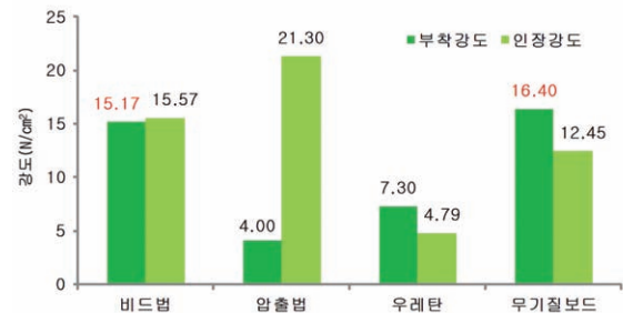
그림 1. 콘크리트와 단열재간 접촉강도
