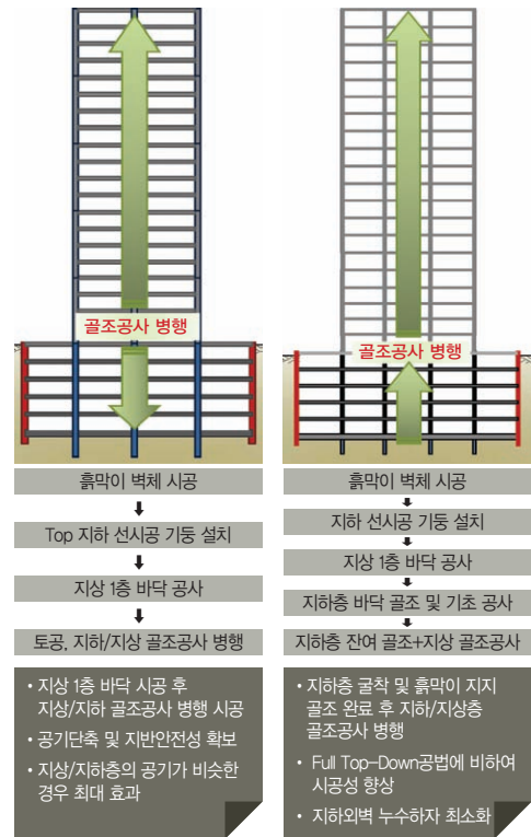
그림 1. Top-Down 공법
