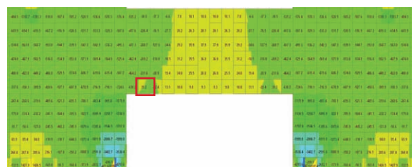
그림 13. 최대 응력(Stress) \sigma_{yy \max} = 35.2 \text{ kN/m}^2
