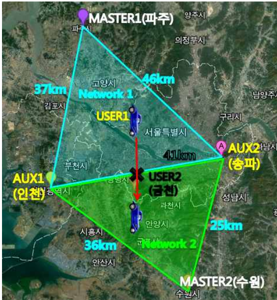
그림 6. 미지정수 수준 조정 검증을 위한 네트워크 구성 Fig. 6. Configuration of networks for evaluating the proposed ambiguity leveling method
