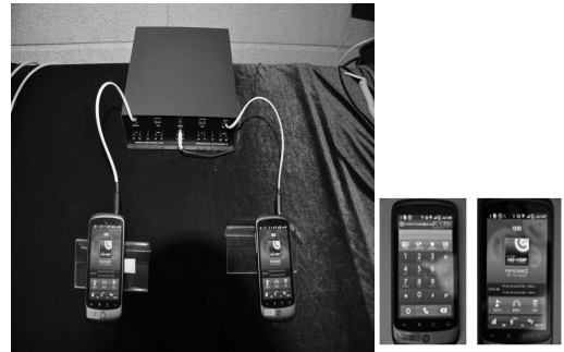
(그림 10) HD 보이스 어플리케이션 음성 품질 측정을 위한 시험 환경
