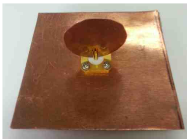
그림 4. 원형 모노폴의 구조와 제작 사진.
