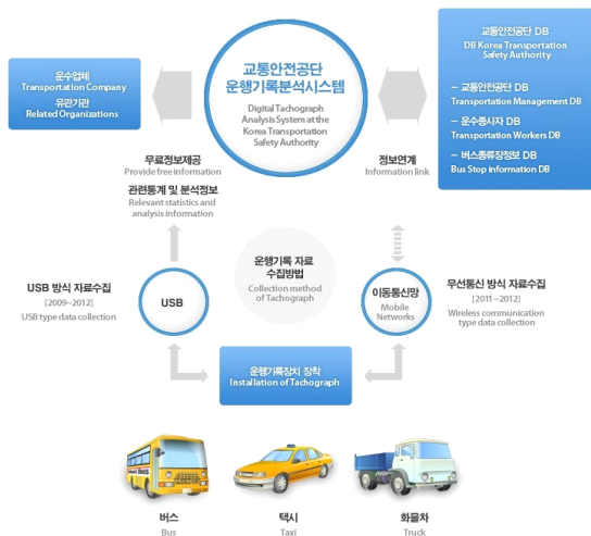
그림 2. eTAS 운행기록분석시스템(10) Fig. 2. eTAS Digital Tachograph Analysis System(10)
