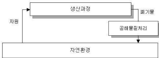
그림1. 공해저감 노력 단계에서는 생산과정에서 나오는 폐기물의 환경영향을 감소시키기 위하여 별도의 공해물질처리 과정을 추가하게 된다. 이 과정은 생산과정과 독립적으로 진행되므로 생산과정의 효율화와는 관계없고, 별도의 비용과 노력이 필요하게 된다.
